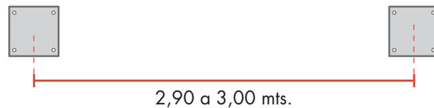
B - Se debera marcar la ubicación de los 4 agujeros elegidos para fijar la placa a la pared y realizar los agujeros con un diametro de 10 mm y una profundidad no menor a 100 mm.
