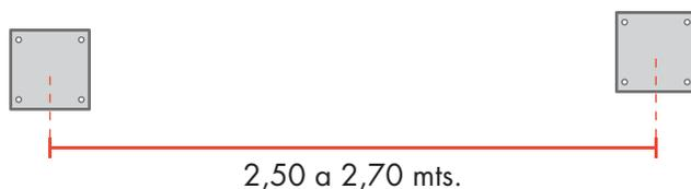
C - Se deberá marcar la ubicación de los 4 agujeros elegidos para fijar la placa a la pared y realizar los agujeros con un diametro de 10 mm y una profundidad no menor a 100 mm.
